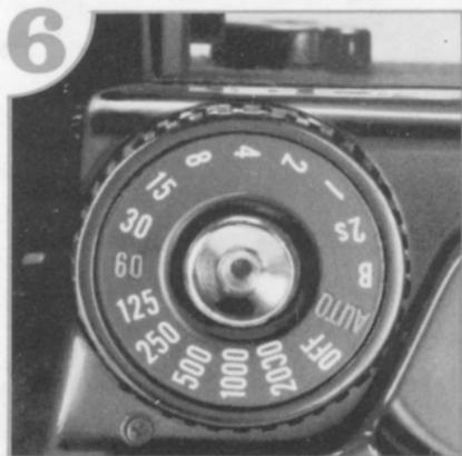
Verschlußzeitenknopf für Aufnahmen mit Belichtungsautomatik auf AUTO stellen.
